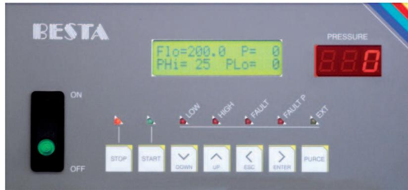
**LED-Display** Das LED-Display ist nur bei den Pumpentypen HD2-200 und HD2-300 vorhanden; es zeigt den gemittelten Druck an (verzögerte Anzeige) und somit den gleichen Wert wie die P=xxx -Angabe im LCD-Display.
